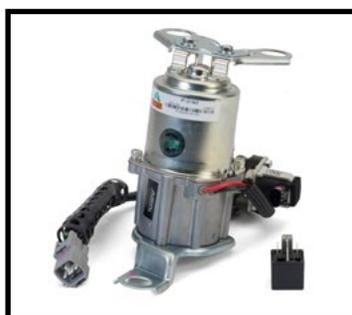
套件提供一个新的打气泵继电器。未使用随产品提供的配件更换该继电器可能会导致产品损坏和/或保修失效。
